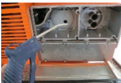
Abb. 62: Filtergehäuse reinigen
