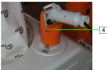
Abb. 15: Steuerkabel anschließen
