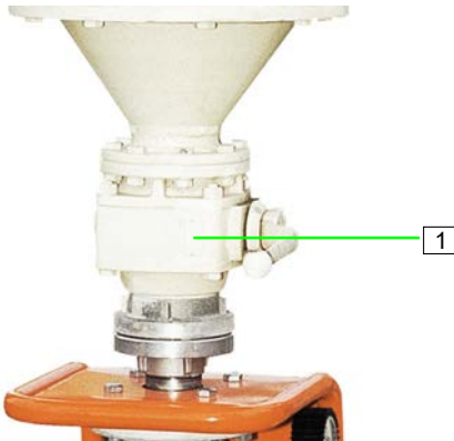
Abb. 34: Siloauslaufklappe schließen
