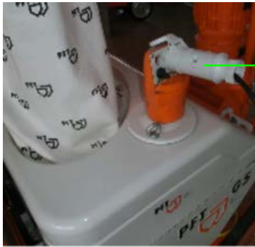
Abb. 32: Steuerstecker abziehen
