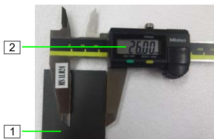
Abb. 53: Schieberbreite kontrollieren
