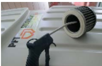
Abb. 61: Filterpatronen reinigen
