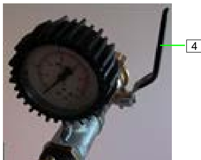
Abb. 25: Absperrhahn öffnen
