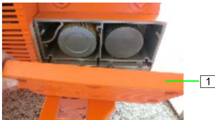
Abb. 59: Filterdeckel lösen
