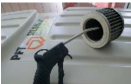
Abb. 57: Filterpatronen reinigen
