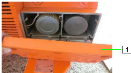
Abb. 55: Filterdeckel lösen
