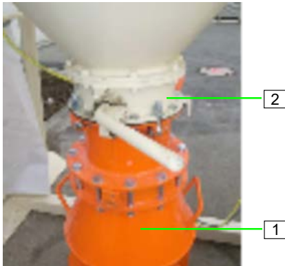
Abb. 14: Fördergefäß anschließen
