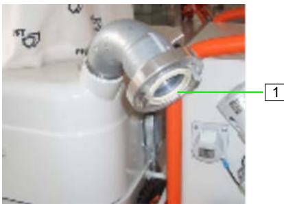
Abb. 15: Förderschlauch anschließen
