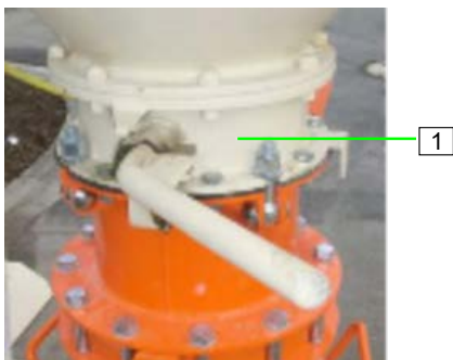
Abb. 18: Siloauslaufklappe öffnen
