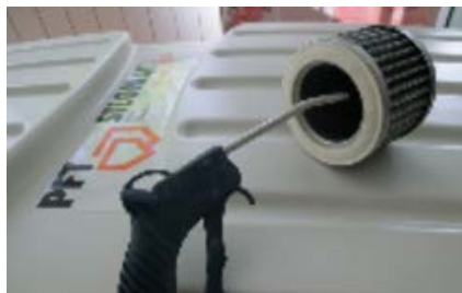
Abb. 52: Filterpatronen reinigen
