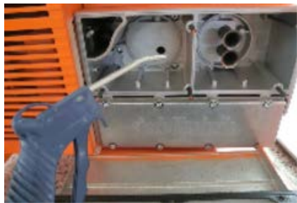
Abb. 53: Filtergehäuse reinigen
