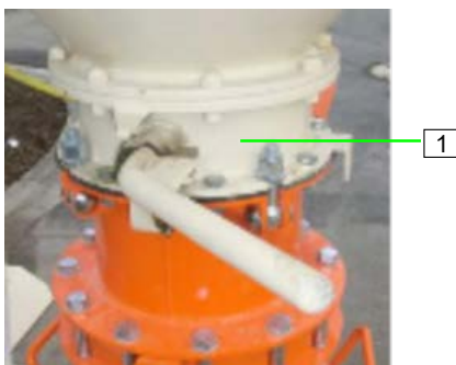
Abb. 26: Siloauslaufklappe schließen
