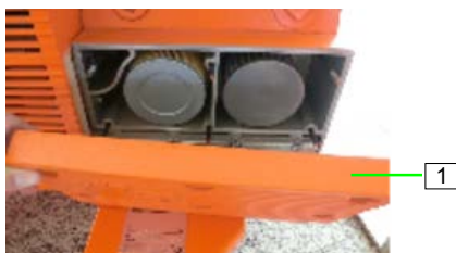
Abb. 50: Filterdeckel lösen
