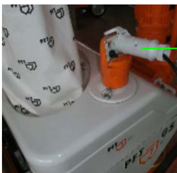
Abb. 28: Steuerstecker abziehen
