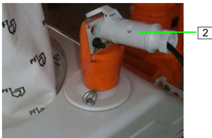
Abb. 14: Steuerkabel anschließen
