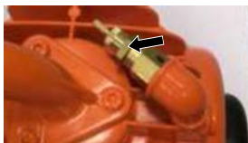
Abb. 62: Sicherheitsventil
