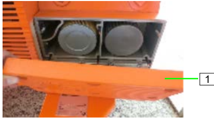
Abb. 53: Filterdeckel lösen
