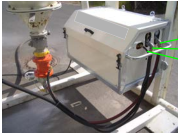
Abb. 16: Luftschläuche anschließen
