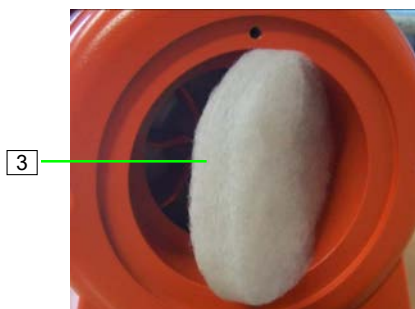
Abb. 60: Filter des Luftkompressors
