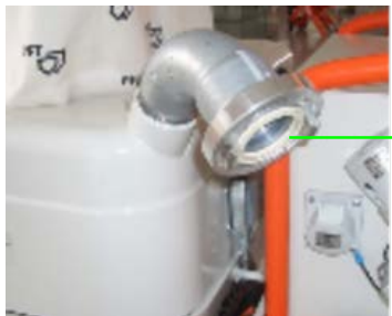
Abb. 18: Förderschlauch anschließen
