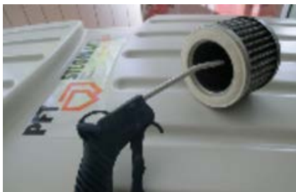
Abb. 55: Filterpatronen reinigen
