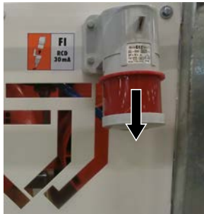
Abb. 41: Stromzufuhr unterbrechen
