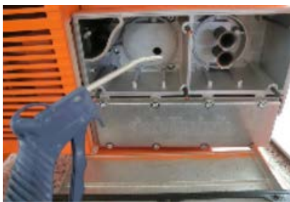
Abb. 56: Filtergehäuse reinigen
