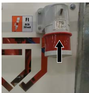
Abb. 12: Stromversorgung anschließen
