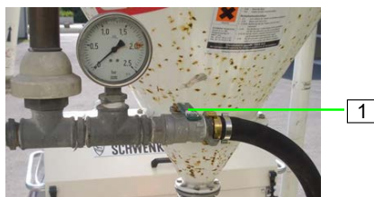
Abb. 21: Lufthahn öffnen
