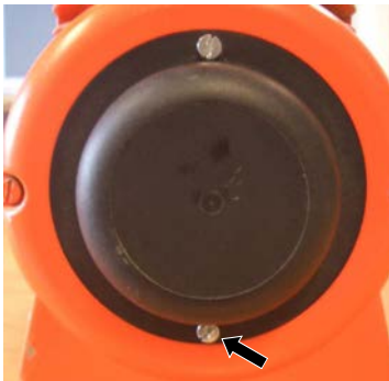
Abb. 61: Öffnung Filterabdeckung
