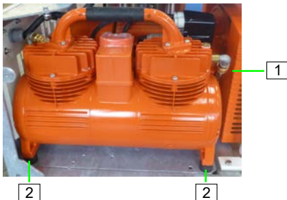
Abb. 59: Luftkompressor entnehmen
