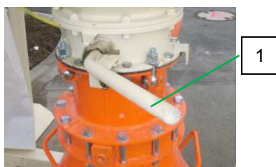
Abb. 32: Siloauslaufklappe schließen
