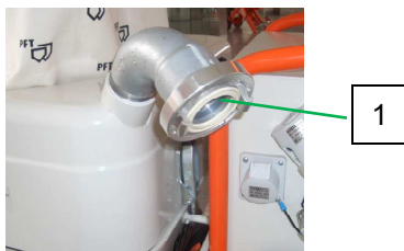
Abb. 10: Förderschlauch anschließen
