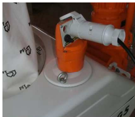
Abb. 14: Steuerkabel anschließen
