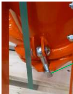
Abb. 36: Augenschrauben öffnen
