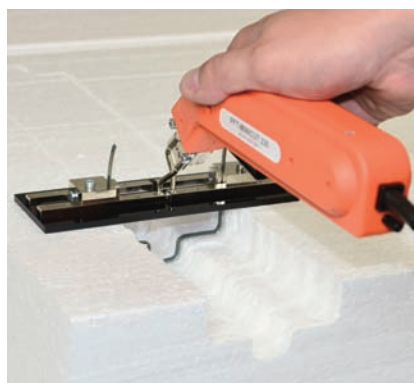
Formas de libre elección, se consiguen doblando simplemente la cuchilla flexible
